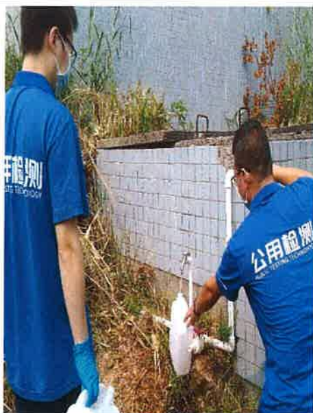
图 1：四堡水厂出厂水采样口
