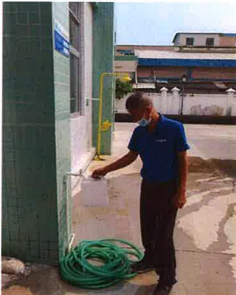
图 1: 桃源加压站采样口
